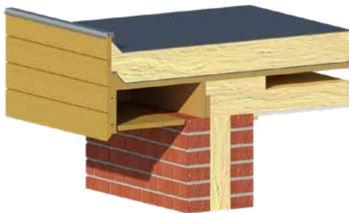
Fig. 18: Stängning av ventilationsöppningar vid tilläggsisolering.
