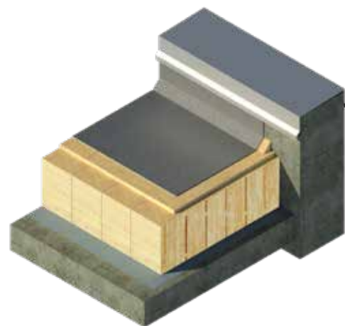
Fig. 4: Isover Robust Lamell på underlag av betong
